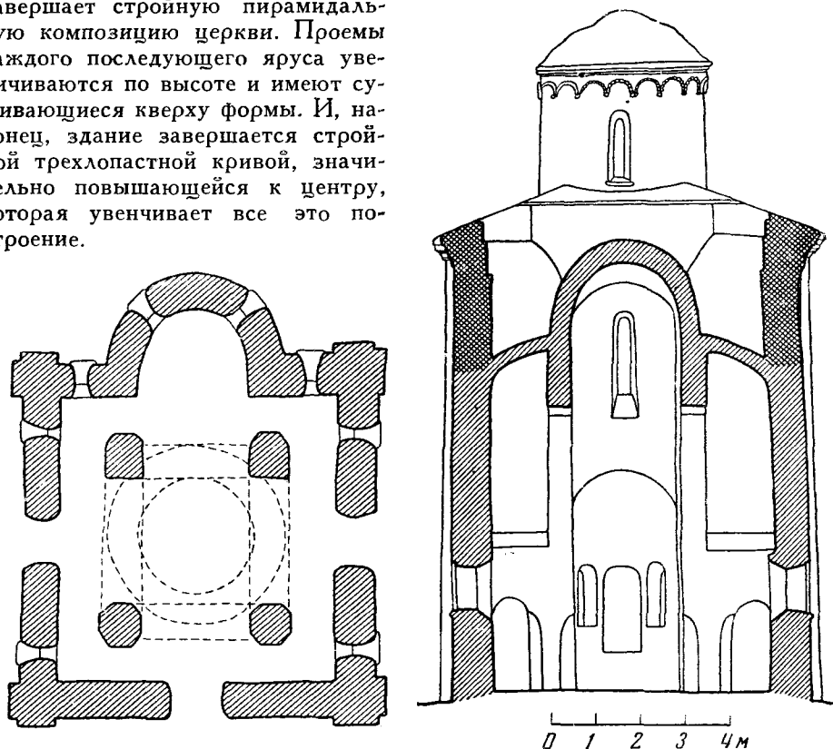
Рис. 10. Церковь в Перинском скиту близ Новгорода. План (реконструкция) и разрез.
